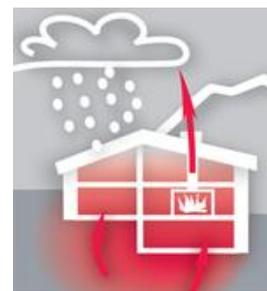
Ob das Radongas ins Haus eindringen kann, hängt in erster Linie davon ab, wie dicht das Haus im Kontakt gegenüber dem Untergrund ist. Risse und Fugen in Wänden und Böden, Öffnungen für die Durchführung von Kabeln und Rohren sowie Kellerböden aus Erde oder Kies (Naturkeller) stellen Eintrittsstellen für Radon dar.
